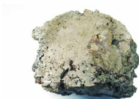
Figura 3. Hierro en bruto, agoa, procedente de la excavación de la ferrería de Arditurri (Oiartzun, Gipuzkoa). Fase I.
